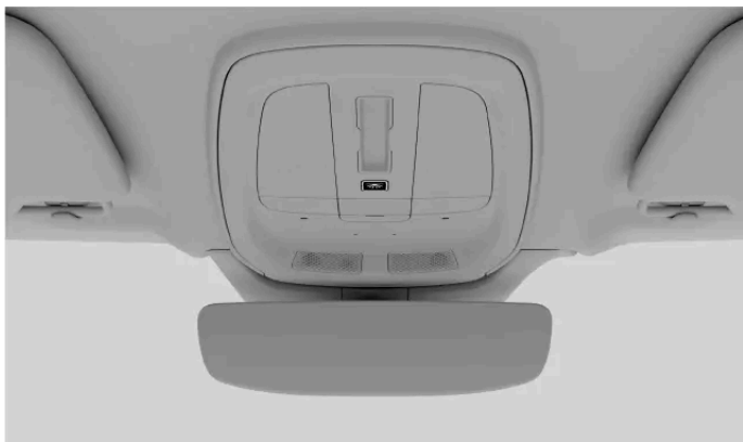
Przycisk automatycznego wyłączania oświetlenia na konsoli sufitowej
