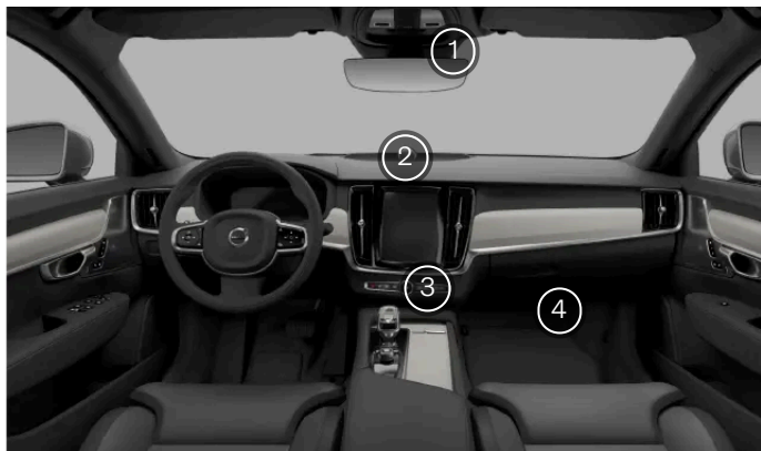
Czujniki klimatyzacji we wnętrzu
