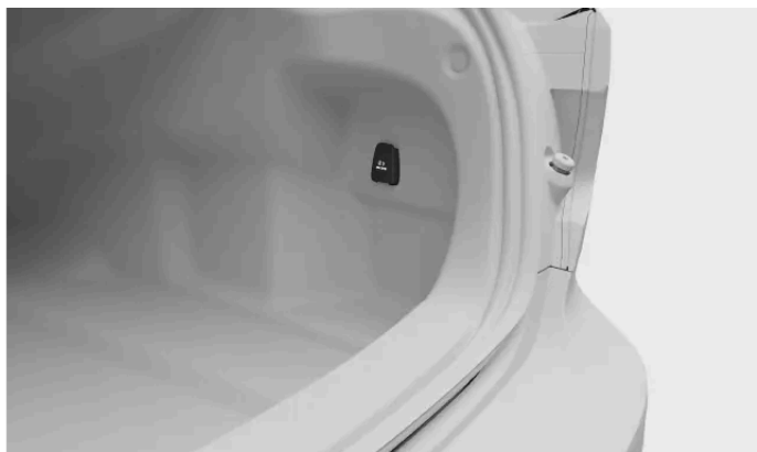
Gniazdo elektryczne 12 V po prawej stronie bagażnika
