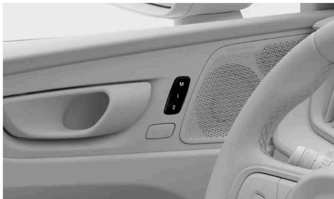
Położenie przycisków zaprogramowanych ustawień fotela
