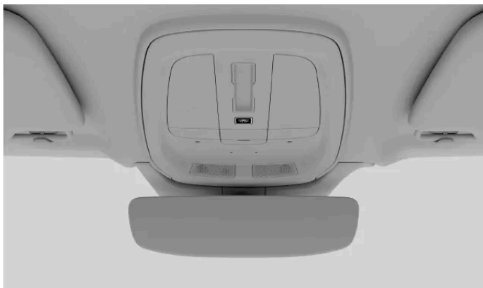
Przycisk automatycznego wyłączania oświetlenia na konsoli sufitowej
