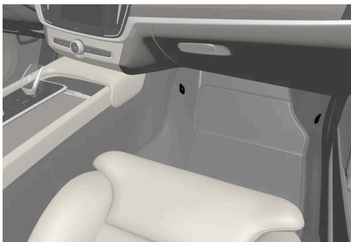
Rozmieszczenie zaczepów mocujących w fotelu przednim.
