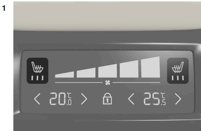
Wskazanie i przyciski podgrzewania siedzeń na panelu klimatyzacji z tyłu konsoli między fotelami.
