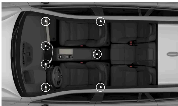
Rozmieszczenie regulowanych nawiewów
