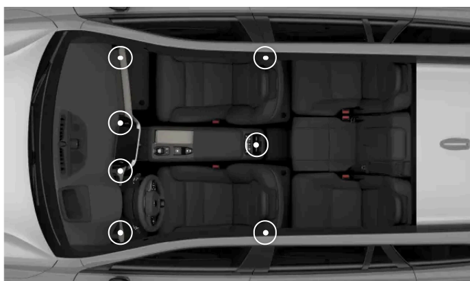
Rozmieszczenie regulowanych nawiewów
