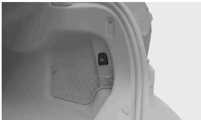
Gniazdo elektryczne 12 V po prawej stronie bagażnika
