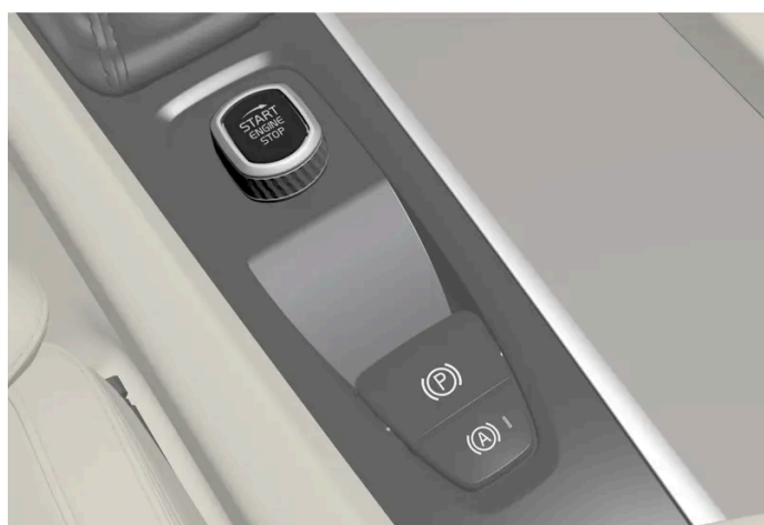
Pokrętło rozruchu na konsoli między fotelami.
