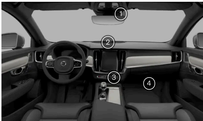
Czujniki klimatyzacji we wnętrzu
