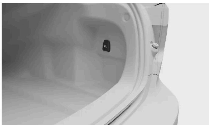
Gniazdo elektryczne 12 V po prawej stronie bagażnika
