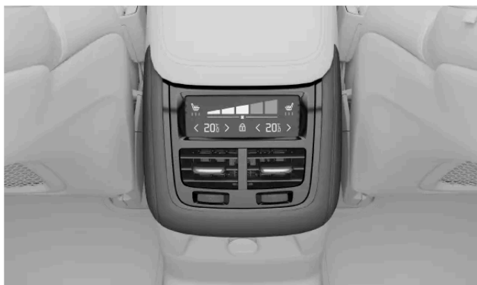
Elementy sterujące klimatyzacją na konsoli między fotelami
