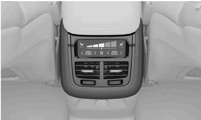
Elementy sterujące klimatyzacją na konsoli między fotelami
