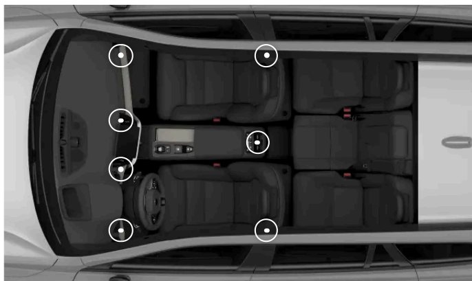
Rozmieszczenie regulowanych nawiewów
