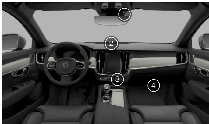
Czujniki klimatyzacji we wnętrzu
