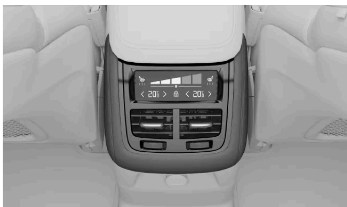
Elementy sterujące klimatyzacją na konsoli między fotelami
