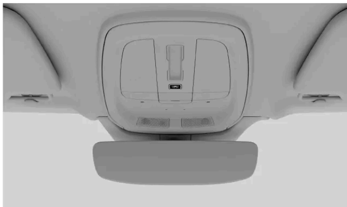
Przycisk automatycznego wyłączania oświetlenia na konsoli sufitowej
