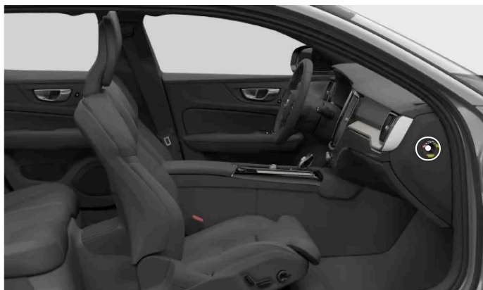
Położenie przełącznika poduszki powietrznej pasażera
