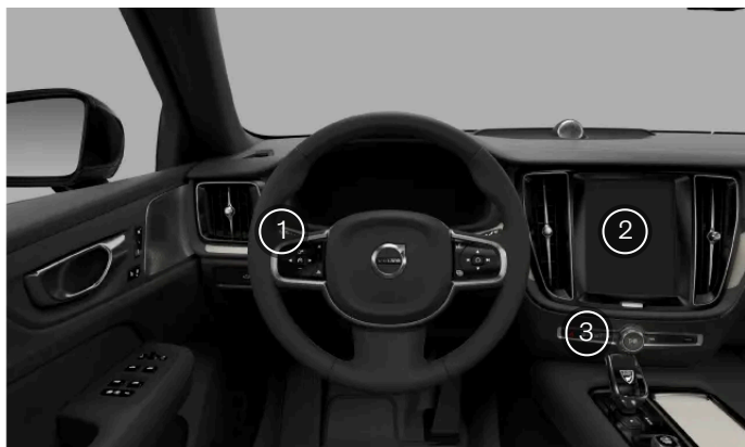
Rozmieszczenie elementów sterujących światłami zewnętrznymi
