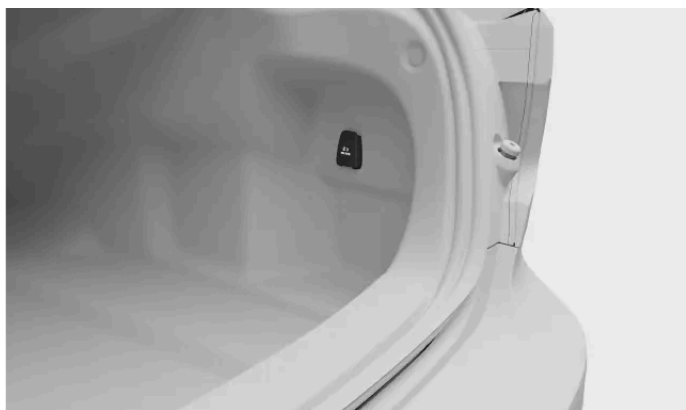
Gniazdo elektryczne 12 V po prawej stronie bagażnika
