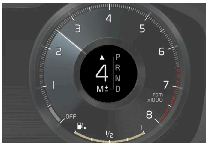
Wskaźnik zmiany biegu na 12-calowym wyświetlaczu kierowcy dla dużej dźwigni zmiany biegów*.
