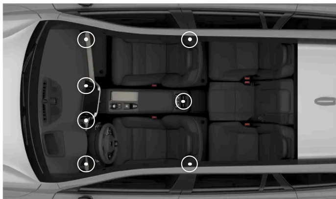
Rozmieszczenie regulowanych nawiewów
