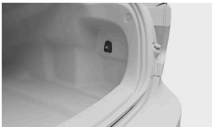
Gniazdo elektryczne 12 V po prawej stronie bagażnika
