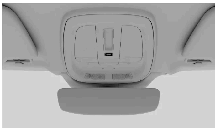
Przycisk automatycznego wyłączania oświetlenia na konsoli sufitowej
