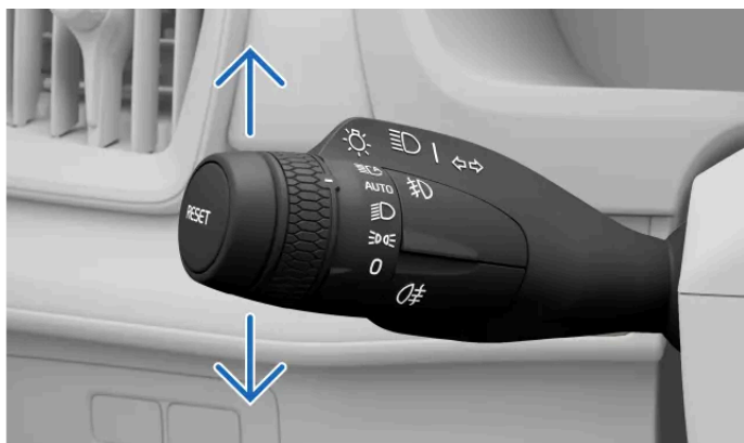
Wskaźniki na lewej dźwigni
