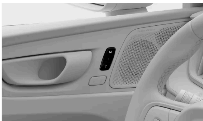
Położenie przycisków zaprogramowanych ustawień fotela
