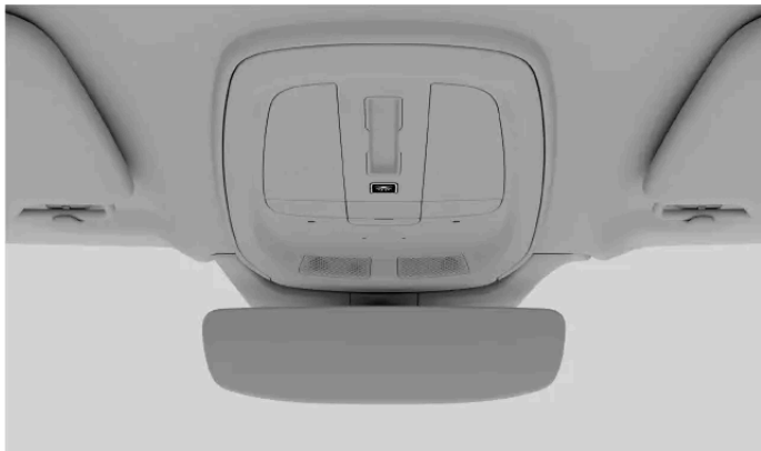
Przycisk automatycznego wyłączania oświetlenia na konsoli sufitowej
