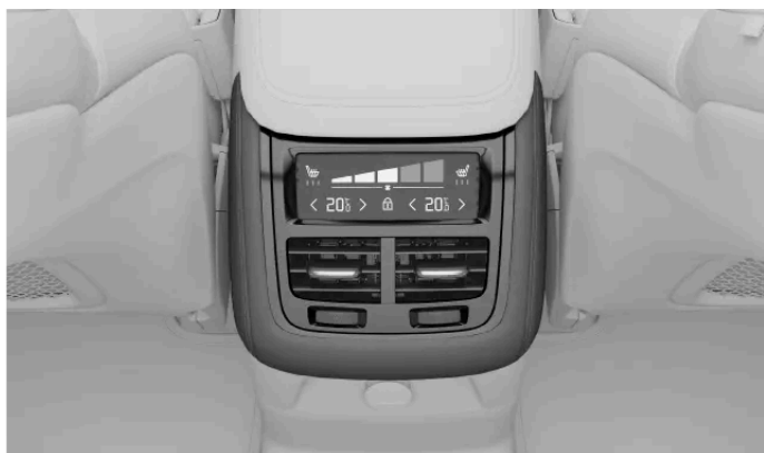
Elementy sterujące klimatyzacją na konsoli między fotelami
