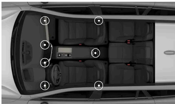
Rozmieszczenie regulowanych nawiewów
