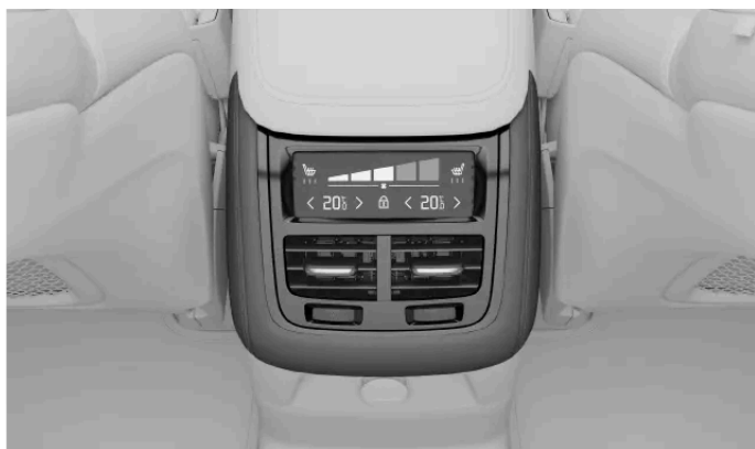
Elementy sterujące klimatyzacją na konsoli między fotelami
