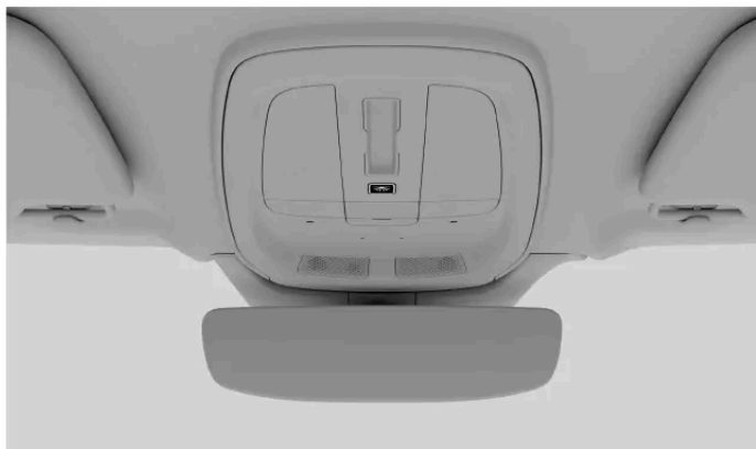
Przycisk automatycznego wyłączania oświetlenia na konsoli sufitowej
