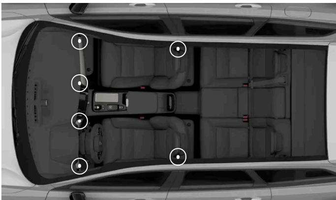
Rozmieszczenie regulowanych nawiewów
