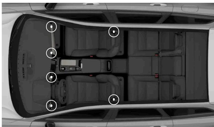
Rozmieszczenie regulowanych nawiewów
