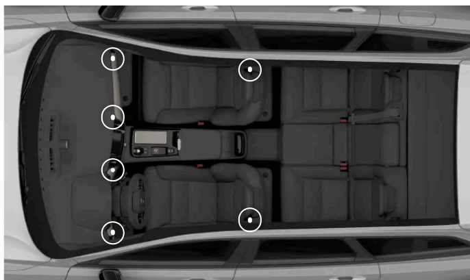
Rozmieszczenie regulowanych nawiewów
