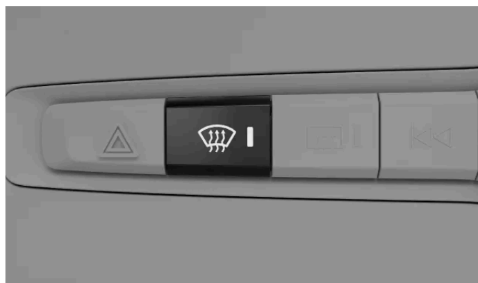
Przycisk maksymalnej intensywności odmrażania na panelu przycisków pod wyświetlaczem centralnym
