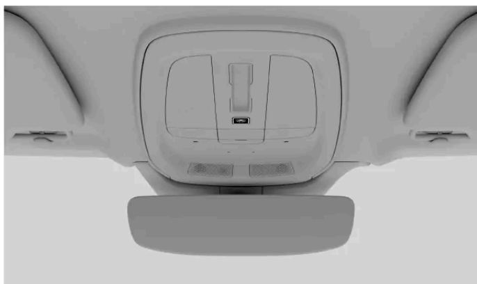
Przycisk automatycznego wyłączania oświetlenia na konsoli sufitowej
