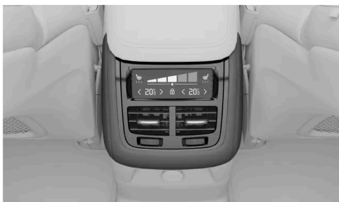
Elementy sterujące klimatyzacją na konsoli między fotelami
