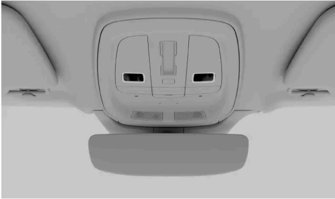
Przednie lampki do czytania w konsoli sufitowej
