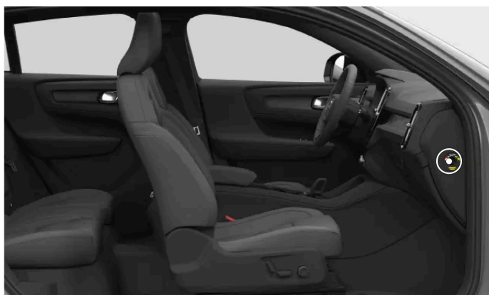
Położenie przełącznika poduszki powietrznej pasażera
