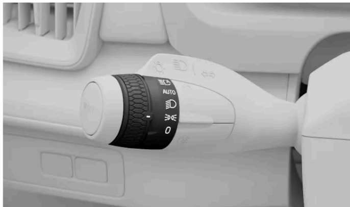
Symbol świateł pozycyjnych na pierścieniu obrotowym na lewej dźwigni
