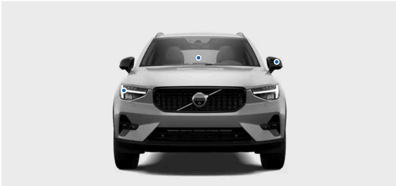
Widok samochodu z przodu przedstawiający światła zewnętrzne, lusterka i wycieraczki szyby przedniej
