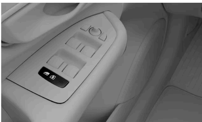
Położenie przycisku blokady tylnych drzwi na panelu drzwi
