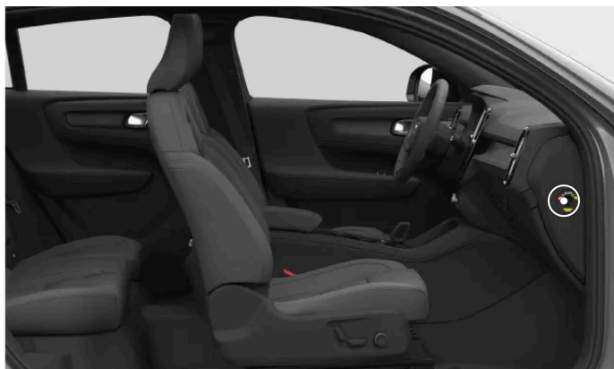
Położenie przełącznika poduszki powietrznej pasażera
