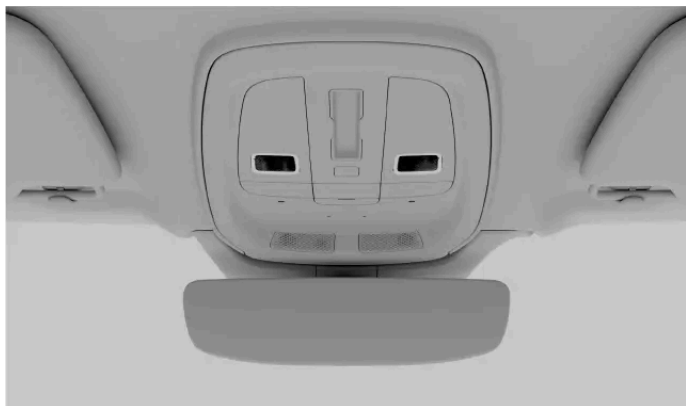
Przednie lampki do czytania w konsoli sufitowej
