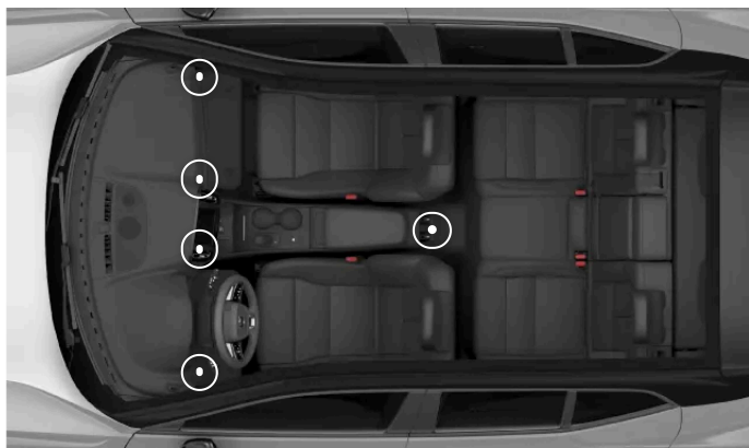
Rozmieszczenie regulowanych nawiewów
