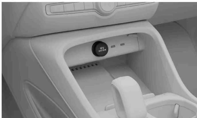
Gniazdo elektryczne 12 V na konsoli między fotelami
