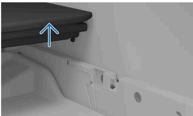
Kłapa wnęki pod podłogą bagażnika zwolniona.
