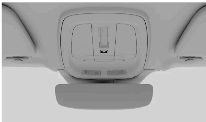
Przycisk automatycznego wyłączania oświetlenia na konsoli sufitowej
