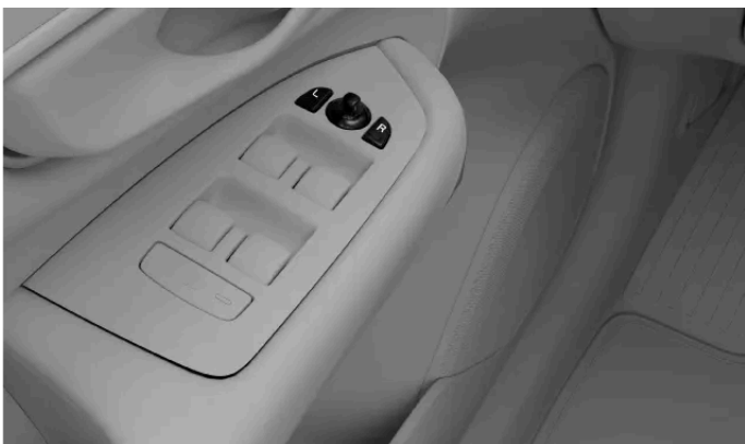
Elementy sterujące regulacją lusterek bocznych
