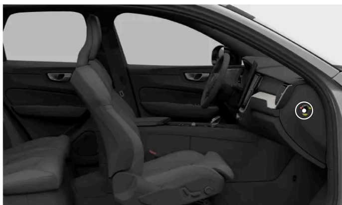
Położenie przełącznika poduszki powietrznej pasażera
