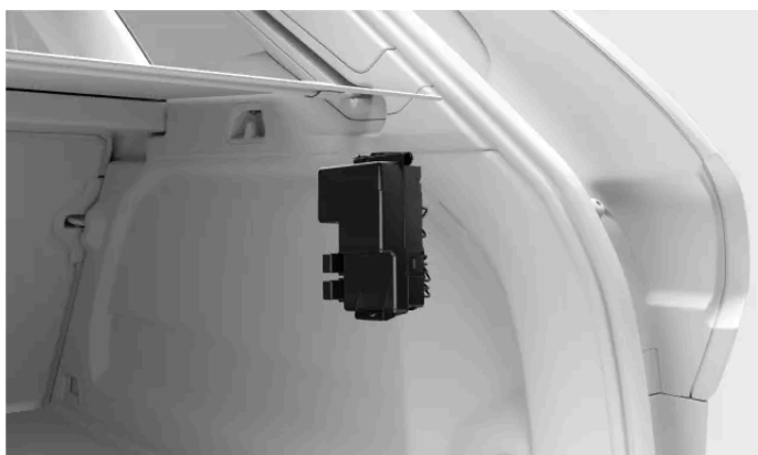
Położenie skrzynki bezpieczników
