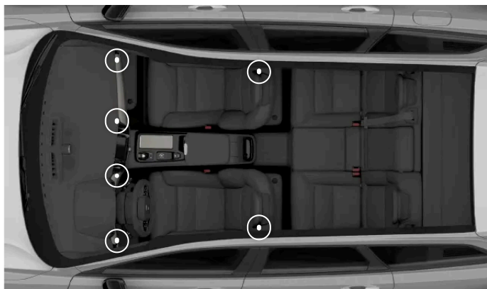
Rozmieszczenie regulowanych nawiewów
