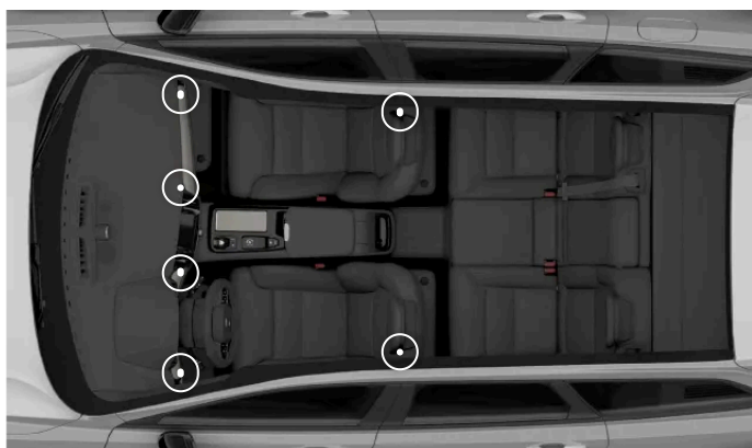
Rozmieszczenie regulowanych nawiewów
