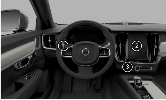
Rozmieszczenie elementów sterujących światłami zewnętrznymi
