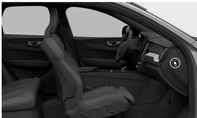
Położenie przełącznika poduszki powietrznej pasażera
