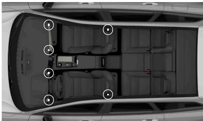
Rozmieszczenie regulowanych nawiewów
