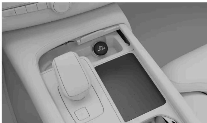
Gniazdo elektryczne 12 V na konsoli między fotelami
