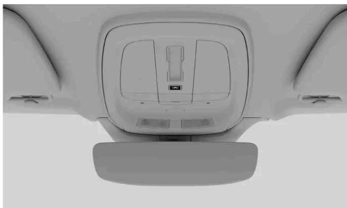
Przycisk automatycznego wyłączania oświetlenia na konsoli sufitowej
