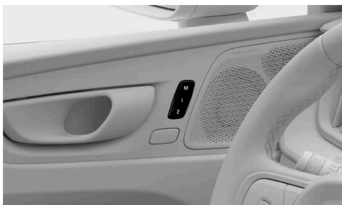
Położenie przycisków zaprogramowanych ustawień fotela
