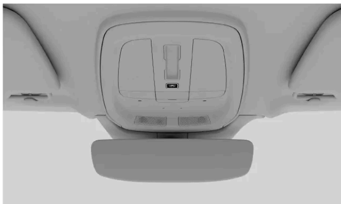
Przycisk włączania pełnego oświetlenia na konsoli sufitowej
