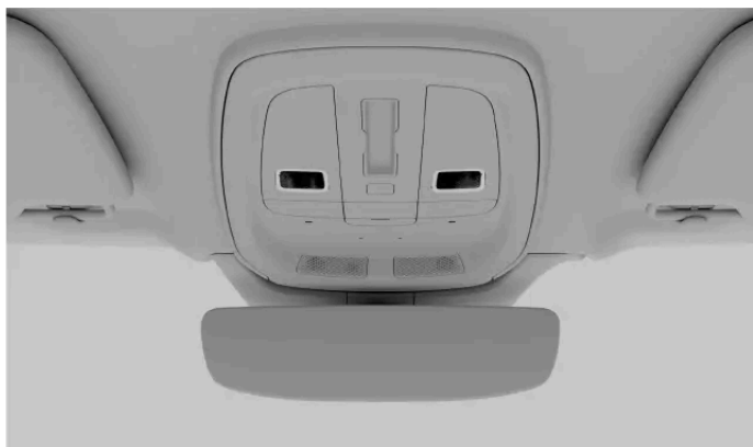
Przednie lampki do czytania w konsoli sufitowej
