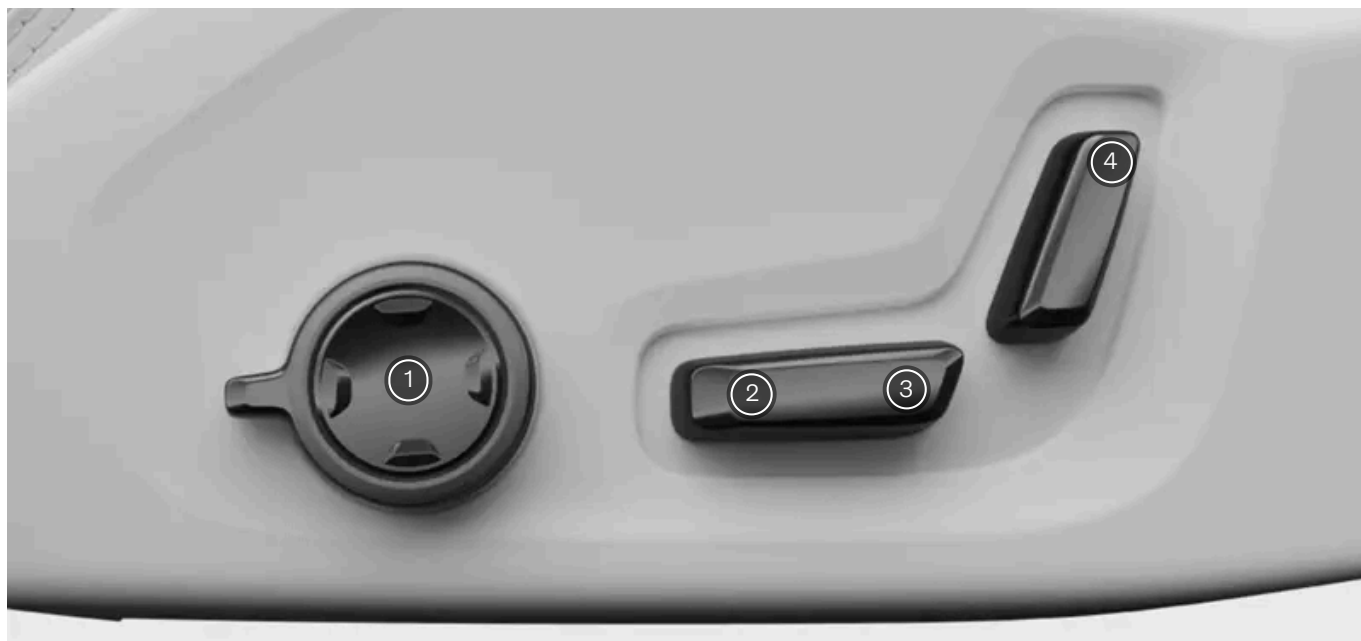
Elementy sterujące z boku fotela
