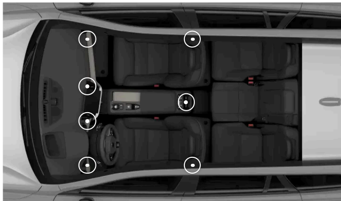
Rozmieszczenie regulowanych nawiewów
