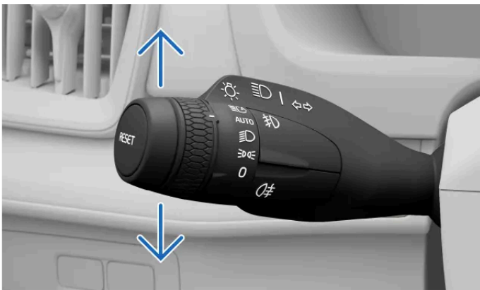
Wskaźniki na lewej dźwigni
