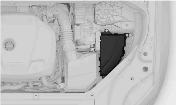
Położenie skrzynki bezpieczników
